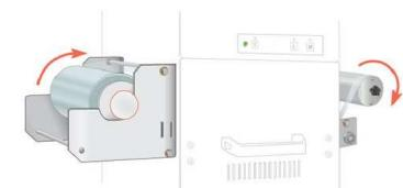
Alla segnalazione di fine ciclo si avvia lo svolgimento del film termosaldabile con recupero automatico dello sfrido di fustellatura. **Dopo 12 secondi dall'avvio del ciclo**, è di nuovo pronta.
